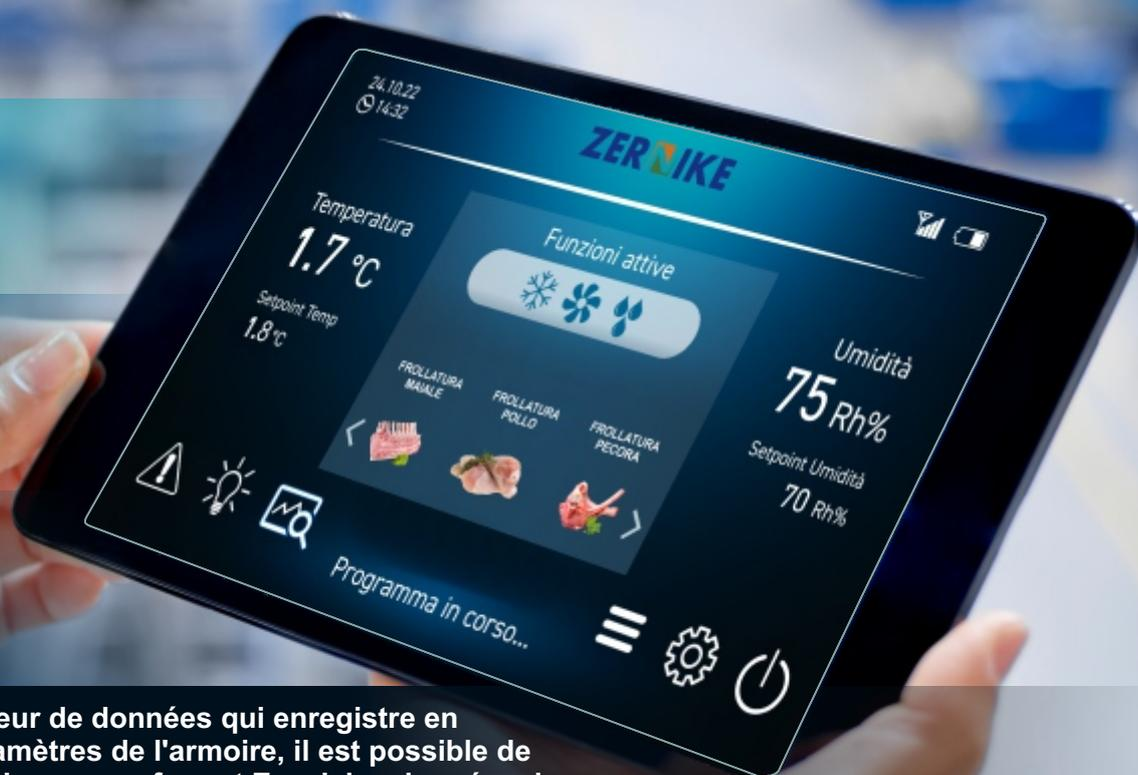
Grâce à un enregistreur de données qui enregistre en continu certains paramètres de l'armoire, il est possible de consulter ou de télécharger, au format Excel, les données de fonctionnement du système, permettant ainsi de détecter d'éventuelles anomalies et d'assurer une traçabilité HACCP 24h/24.
