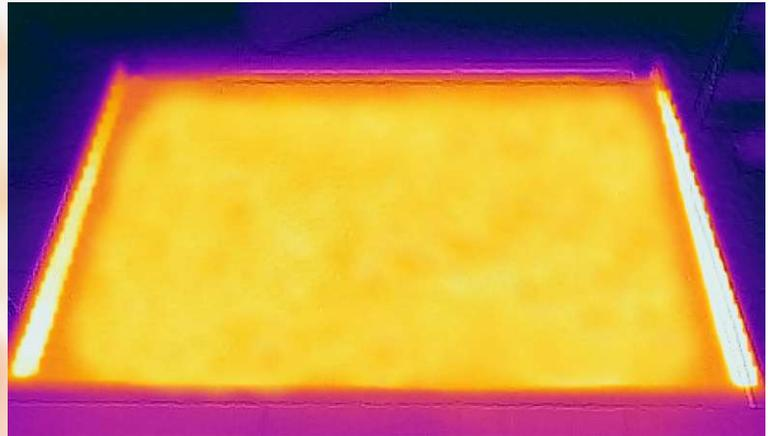
\* Piadacooking Evolution photographié avec dispositif thermographique de relevé de chaleur. Dans l'image prise au moment de la réalisation de la température choisie, on peut noter la grande uniformité sur toute la surface de la plaque.
