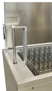
Les modèles **MW-UP** sont équipés d'un piston qui soulève automatiquement le panier. Tout le confort avec un minimum d'effort.
